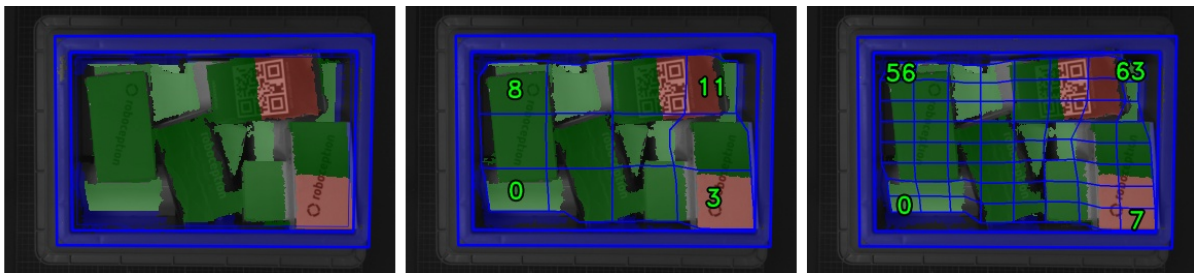
Abb. 5.10: Visualisierungen des Behälterfüllstands: Gesamtfüllstand ohne Raster (links), 4x3 Raster (Mitte), 8x8 Raster (rechts). Der Inhalt wird mit einem Farbverlauf von weiß (auf dem Boden) nach dunkelgrün dargestellt. Die überfüllten Bereiche sind rot dargestellt. Die Nummern stellen die Zell-IDs dar.
