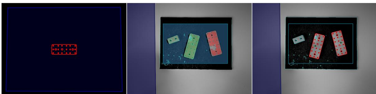
Abb. 6.19: „Template“, „Zwischenergebnis“ und „Ergebnis“ Bilder des *SilhouetteMatch* Moduls in der Web GUI für eine Detektion mit automatischer Objektebenenerkennung (`object_plane_detection` ist `true`)
