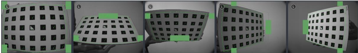
Abb. 6.37: Musterposen für die Monokalibrierung
