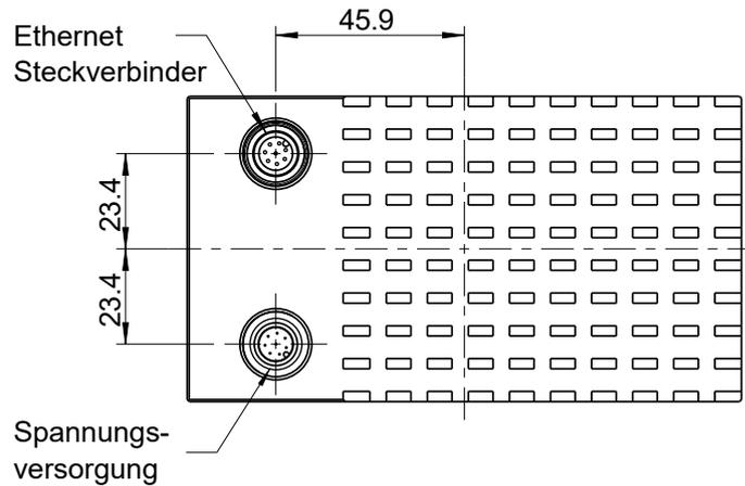
Abb. 3.4: Lage der elektrischen Anschlüsse des *rc\_visard* für die Ethernetverbindung (oben) und die Stromversorgung (unten)
