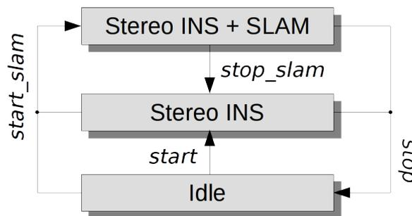
Abb. 6.5: Vereinfachtes Zustandsdiagramm
