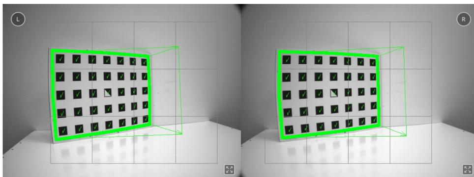
Abb. 6.33: Pfeile weisen darauf hin, wenn das Muster während der Stereokalibrierung nicht senkrecht zur Blickrichtung der Kamera gehalten wird.
