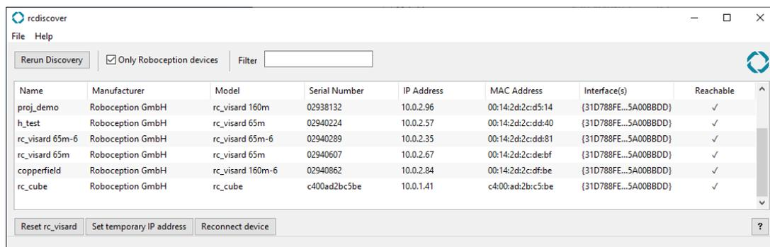
Abb. 4.2: *rcdiscover-gui*-Tool zum Aufspüren angeschlossener GigE Vision®-Geräte
