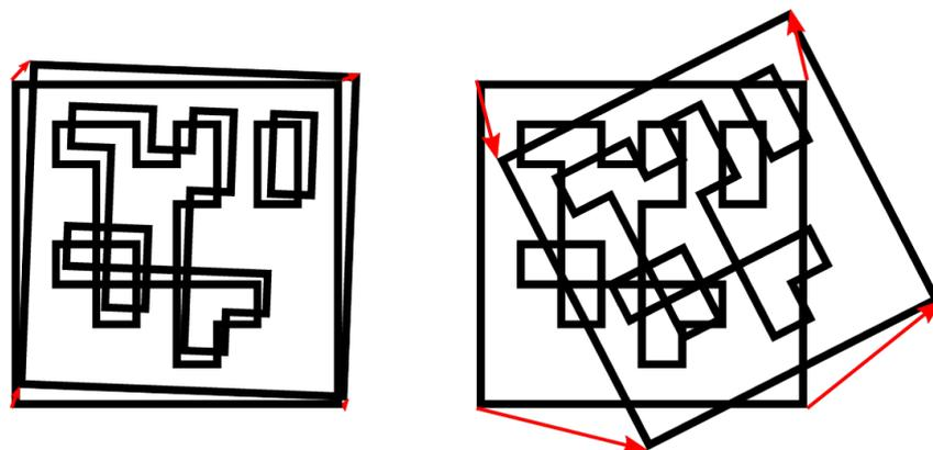
Abb. 6.14: Vereinfachte Darstellung der Tag-Wiedererkennung. Die euklidischen Abstände zwischen zusammengehörigen Tagecken in 3D werden berechnet (rote Pfeile).
