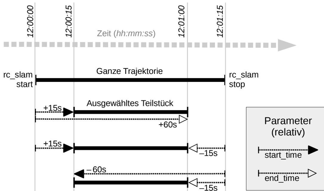
Abb. 6.7: Beispielhafte Kombinationen positiver und negativer relativer Zeitangaben. Alle gezeigten Kombinationen resultieren im gleichen Teilstück.
