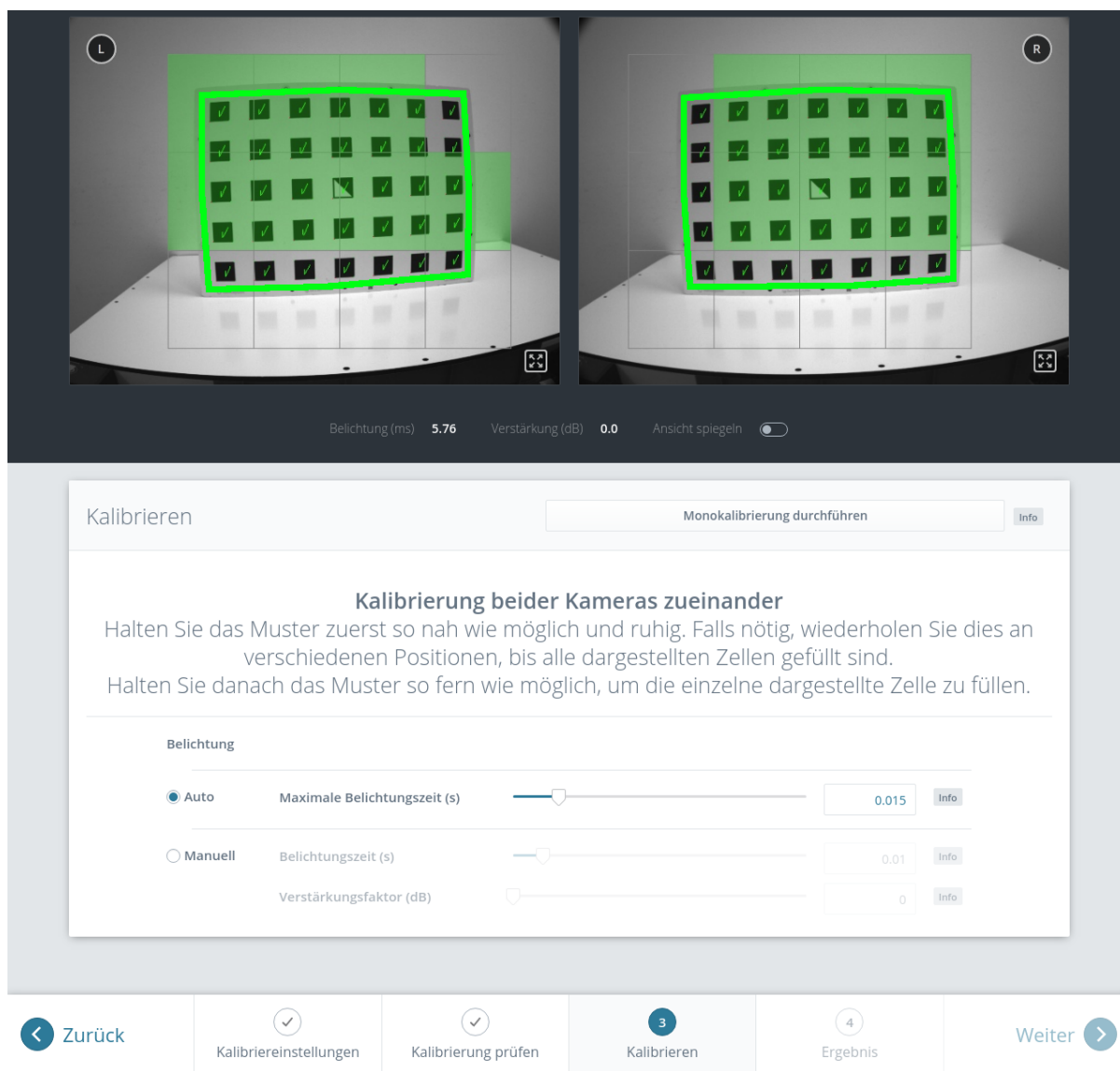
Abb. 6.34: Stereokalibrierung: Das Muster sollte so nah wie möglich gehalten werden, um alle dargestellten Zellen zu füllen.
