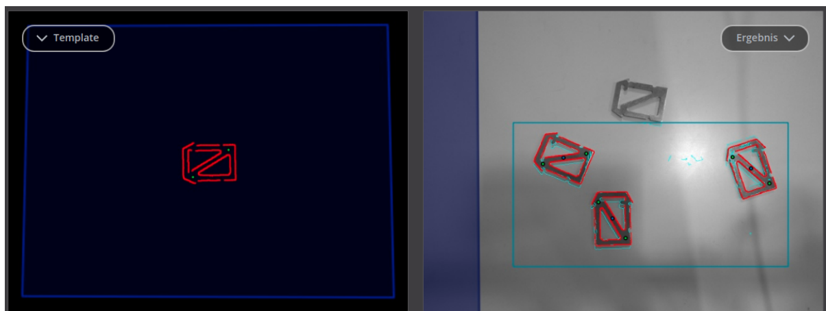
Abb. 6.19: Ergebnisbild des SilhouetteMatch-Moduls, wie über die Web GUI dargestellt
