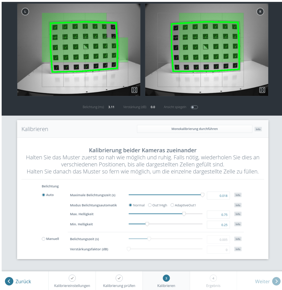
Abb. 6.35: Stereokalibrierung: Das Muster sollte so nah wie möglich gehalten werden, um alle dargestellten Zellen zu füllen.
