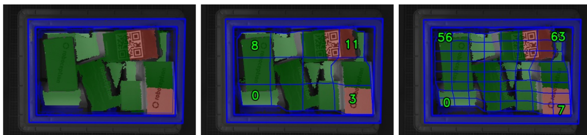
Abb. 6.10: Visualisierungen des Behälterfüllstands: Gesamtfüllstand ohne Raster (links), 4x3 Raster (Mitte), 8x8 Raster (rechts). Der Inhalt wird mit einem Farbverlauf von weiß (auf dem Boden) nach dunkelgrün dargestellt. Die überfüllten Bereiche sind rot dargestellt. Die Nummern stellen die Zell-IDs dar.
