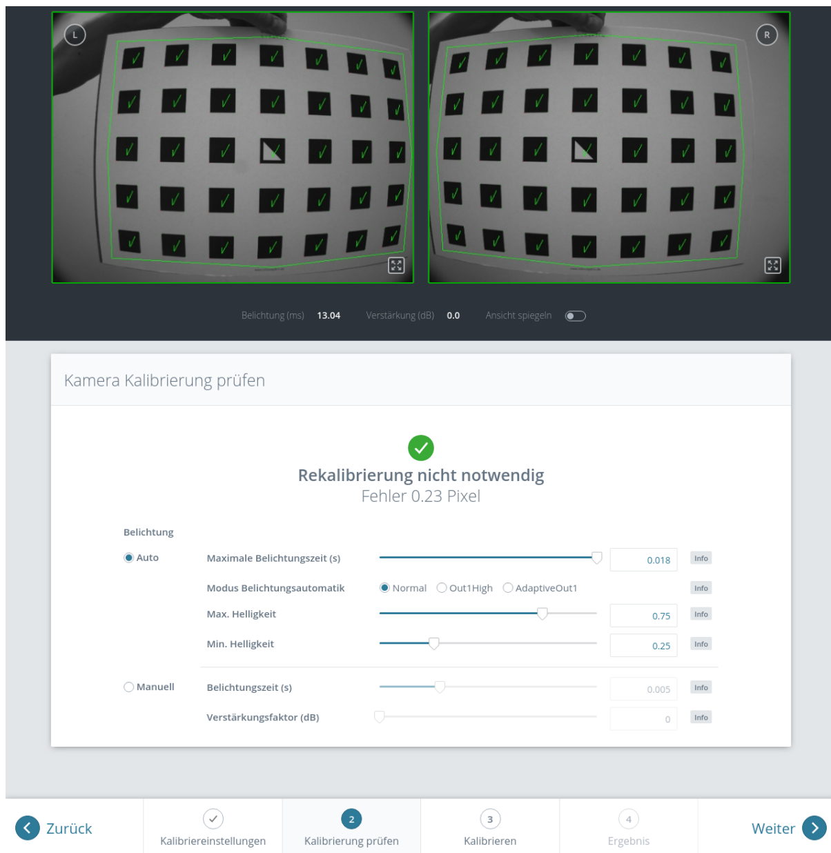
Abb. 6.33: Überprüfung der Kalibrierung
