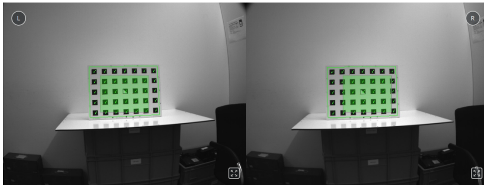
Abb. 6.36: Positionierung des Musters so entfernt wie möglich während der Stereokalibrierung
