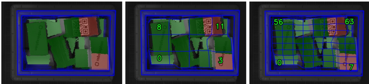
Abb. 7.10: Visualisierungen des Behälterfüllstands: Gesamtfüllstand ohne Raster (links), 4x3 Raster (Mitte), 8x8 Raster (rechts). Der Inhalt wird mit einem Farbverlauf von weiß (auf dem Boden) nach dunkelgrün dargestellt. Die überfüllten Bereiche sind rot dargestellt. Die Nummern stellen die Zell-IDs dar.
